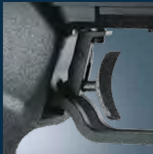
Druckpunkt abzug 1000 g Trigger weight 1000 g ▪ Fingerlage, drehbar in 3 Achsen. ▪ Minimaler kurzer Vorzug für OSP einstellbar. ▪ Finger position rotatable in three axes. ▪ Minimum short slack adjustable for OSP.
